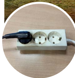
Oben: Fettexplosion ; links: Verteilersteckdose mit Schmelbrandrückständen
